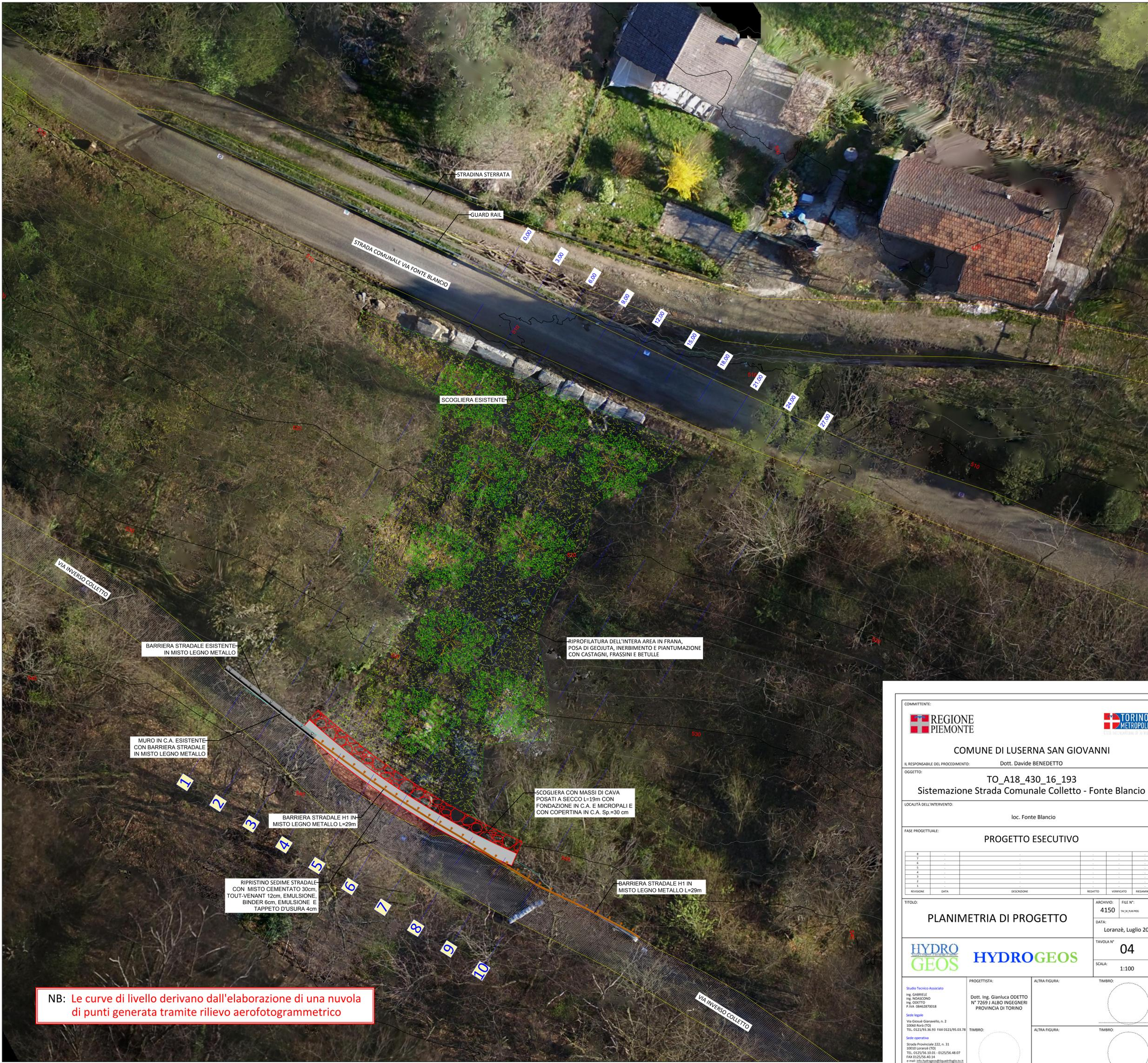
**NB:** Le curve di livello derivano dall'elaborazione di una nuvola di punti generata tramite rilievo aerofotogrammetrico
